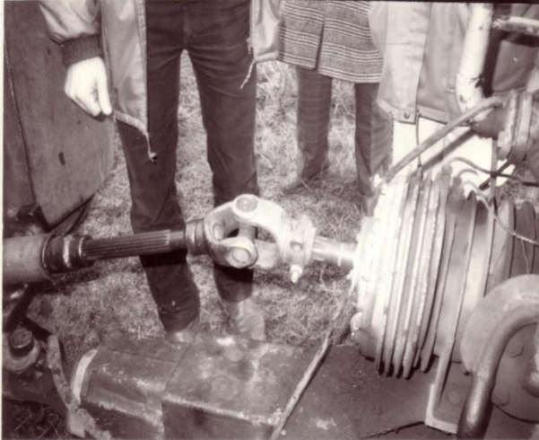
A kardántengely burkolat nélkül
